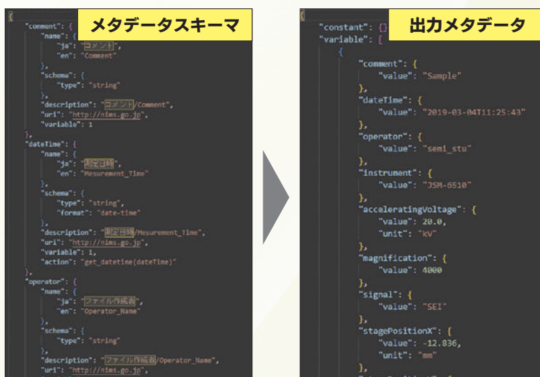
図：RDEにおける選定メタデータの定義スキーマとそれから得られる出力メタデータ
