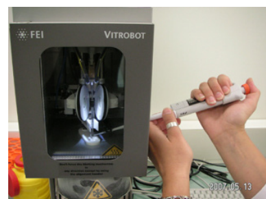
グリッドに試料溶液をのせる。 液体エタンで急速凍結。
