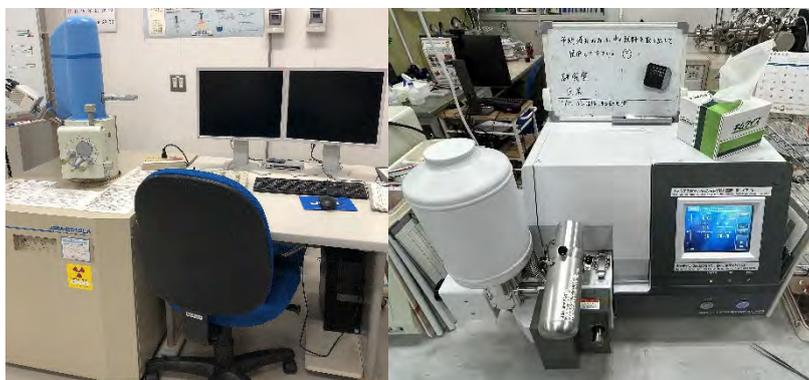
図 1. (左) EDS 搭載走査型電子顕微鏡. (右) CCP.
