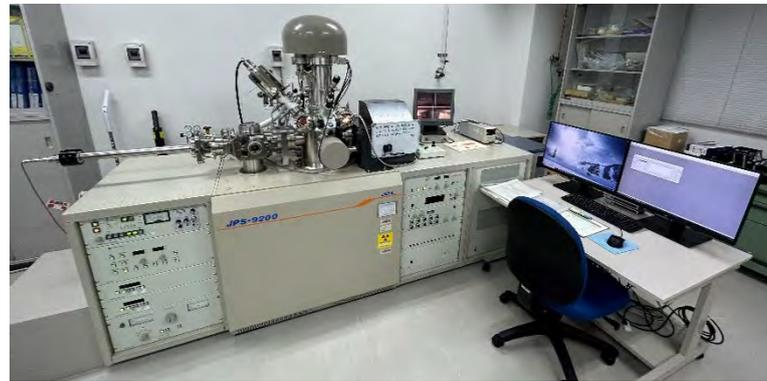
図 5. X 線光電子分光装置
