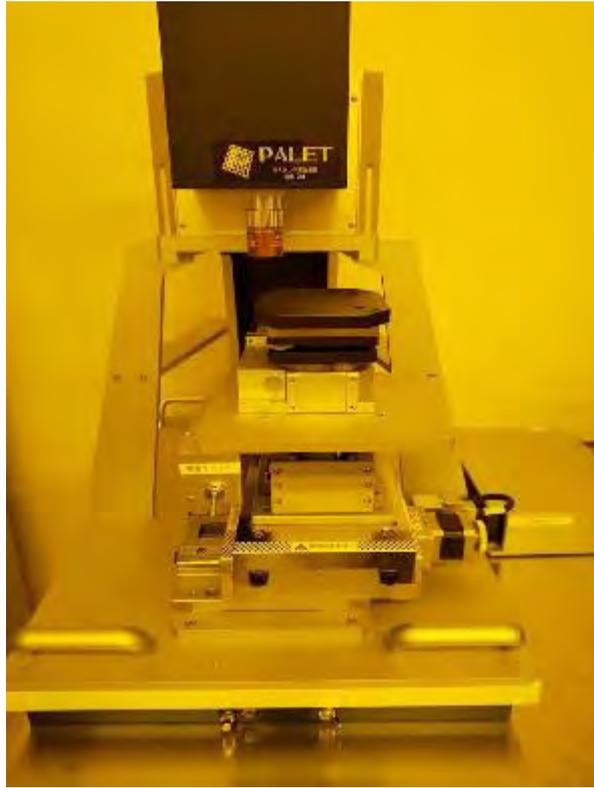
図 3 マスクレス露光装置（ネオアーク社 PALET DDB-701）
