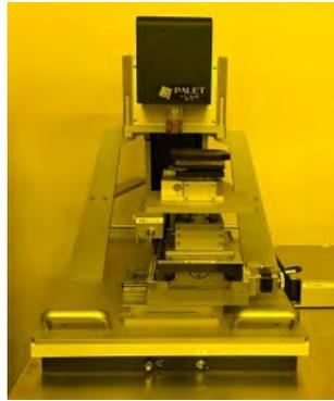
図 2 マスクレス露光装置 (PALET)
