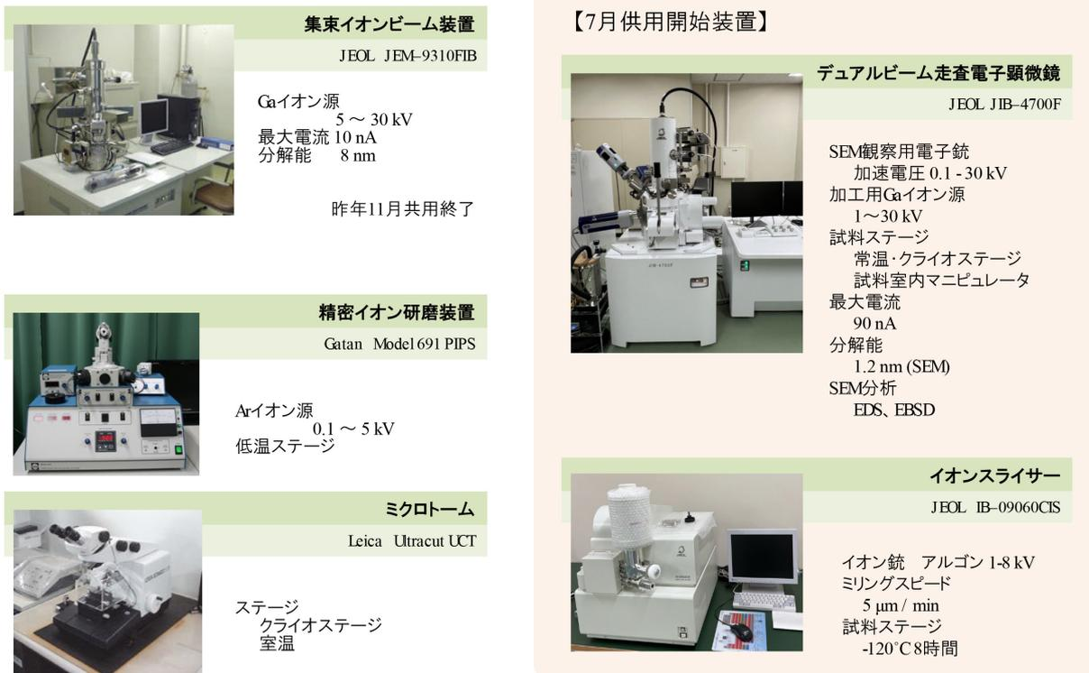
図2 京大 ARIM 共用設備の試料作製装置群；(左上) FIB 装置, (右上) FIB/SEM デュアルビーム装置
