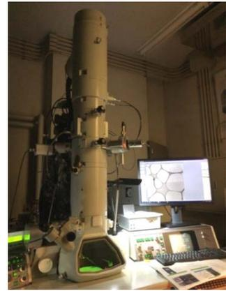
Fig. 9 透過電子顕微鏡
