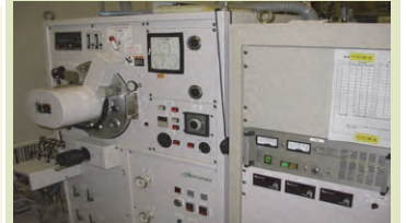
スパッタ(金属、絶縁体)蒸着装置 芝浦エレクトロニクスQPS-4ES ・平行平板型、ターゲット裏面(TiAlAgPdSiO2Al2O3, SiN, Au)
