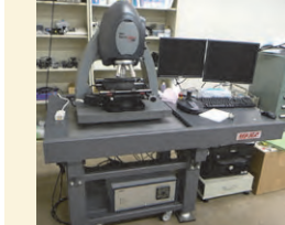
非接触3次元表面形状・粗さ測定機 Zygo® NeoView 7300 システム(食・フィルム、動的オブジェクト) 白色干渉計 ・材料は不同 ・サイズはステージに載れば可能
