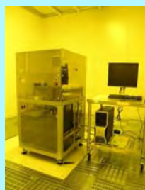
マスクレス露光装置 最小画素1 μm 厚膜レジストの露光可能
