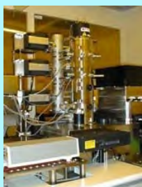
電子線描画装置 可変成形成 加速電圧50kV 最小線幅50nm
