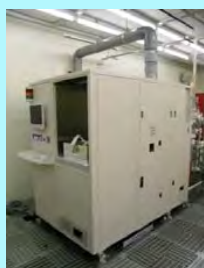
深掘エッチング装置 アスペクト比30 側面粗さ20nm、625 μmの シリコンウエハ貫通孔形成可能
