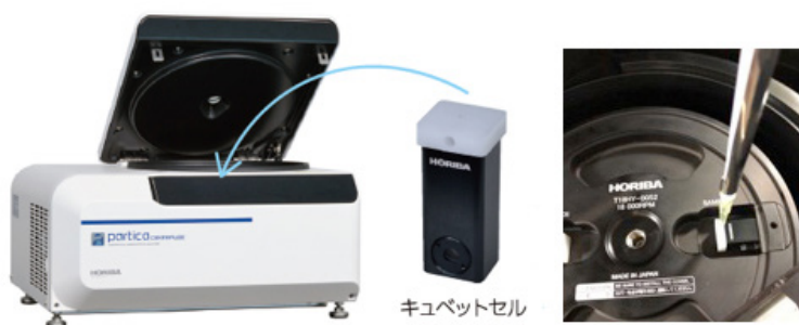
図 17 遠心式ナノ粒子解析装置にキューベットセルを装着し、回転前に試料を注入
