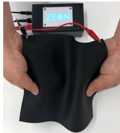
図 18 柔軟な導電性 ZEONANO®SG101 シリコンゴムシート
