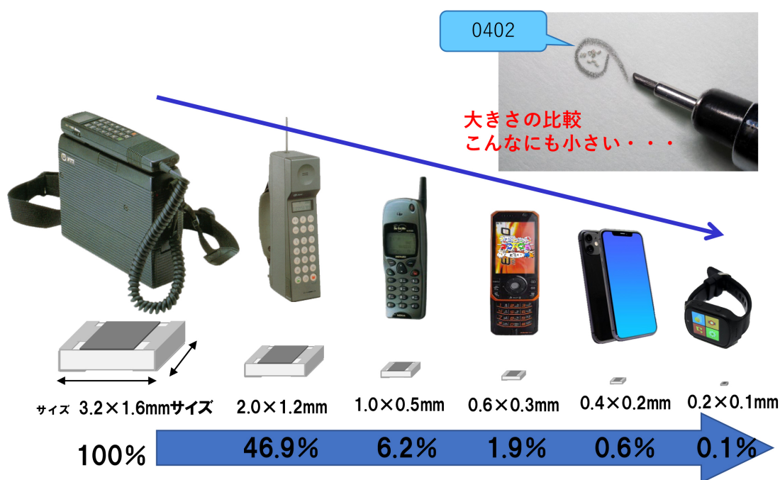
図2 通信機器の小型／高機能化とチップ部品の変化： 携帯電話機誕生の約39年前は3.2 × 1.6mm サイズ（3216 サイズと表現）が2015年には0201サイズへ
