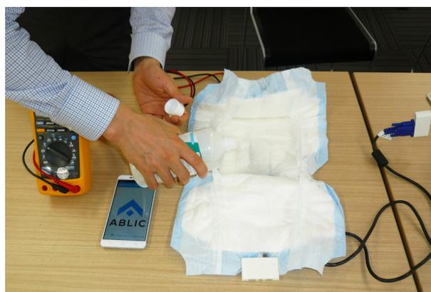
図7 おむつセンサに食塩水を滴下してセンサ出力電圧を測定するデモ
