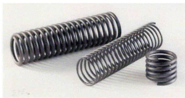
図 13 PFC 成形品 (左) カーボンスプリング (右) ステンレスとの曲げ強度比較
