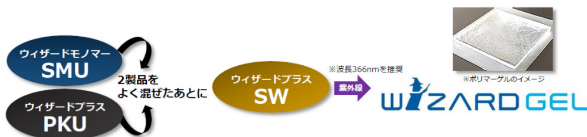
図16 ウィザードパック熱によるウィザードゲルの作製
