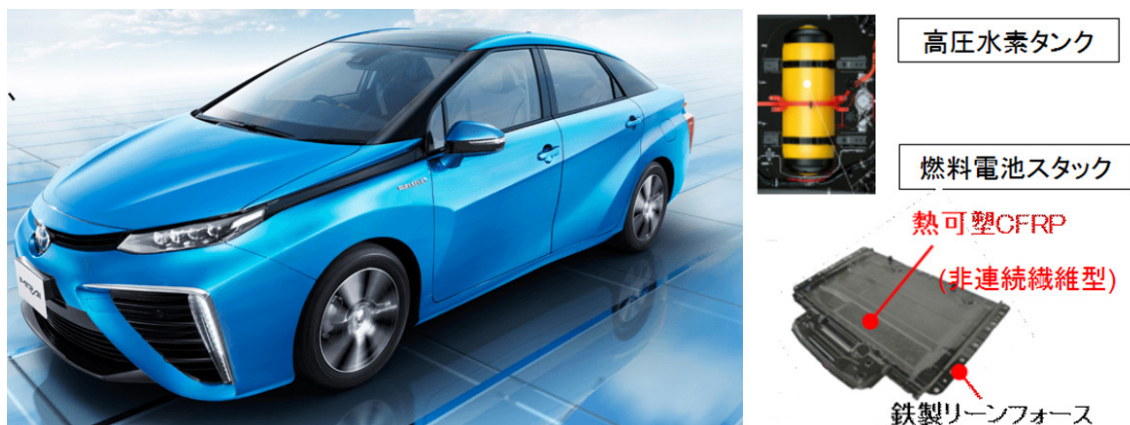
図5 燃料電池車 Toyota Mirai でのCFRP適用状況
