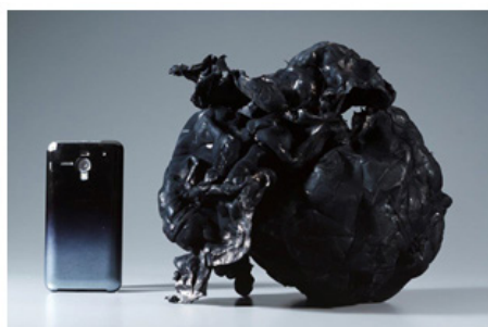
図 4 開発した工業生産プラントで合成した SWNT の塊（左、比較はスマートフォン）とシート状（直径 15cm）に加工した高純度（99% 以上）の単層カーボンナノチューブ（右）
