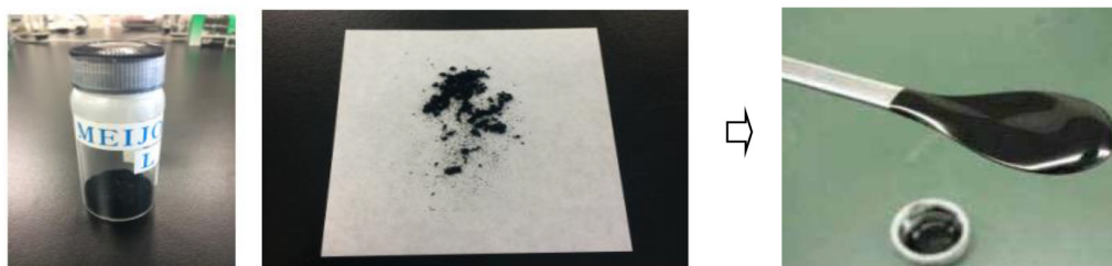
図8 “MEIJO eDIPS-L”（左：分散の中間体。粉っぽい）および導電ペースト（右：塗布膜は 10^{-3}\Omega \cdot \text{cm} ）
