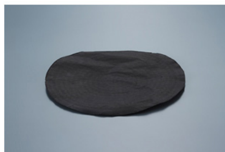
図 4 開発した工業生産プラントで合成した SWNT の塊（左、比較はスマートフォン）とシート状（直径 15cm）に加工した高純度（99% 以上）の単層カーボンナノチューブ（右）
