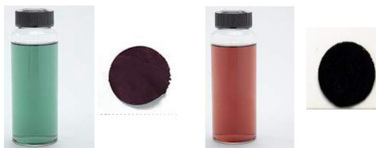
図9 金属型および半導体型SWNTの分散液とこれを抄いて紙状にしたもの （左）金属型SWNT、（右）半導体型SWNT （SWNTはそれぞれ直径1.4nm、炭素純度>99%、分散液の溶媒は水、SWNT濃度1mg/10ml）
