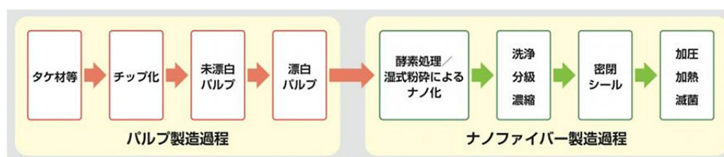
図 4 竹のナノファイバー製造プロセス [13]
