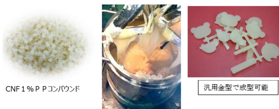
図8 杉セルロースナノファイバー添加の強化プラスチック成型
