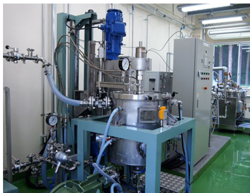
図 7 セルラーゼ酵素を投入するナノファイバー化前処理装置
