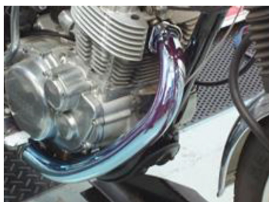
(c) 冷却途中のエキパイ (赤みが残っている)
