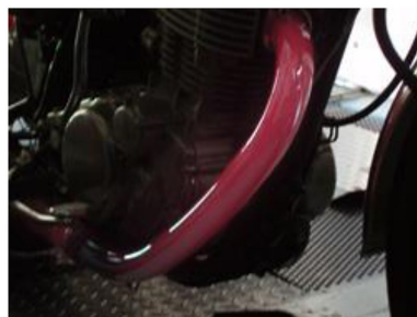
(b) 加熱試験中の様子 (真っ赤なエキパイ)
