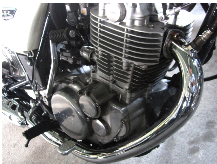
図6 約 25,000km 走行後の SixONy™ 排気管 (SR400) 変色・錆の発生なし
