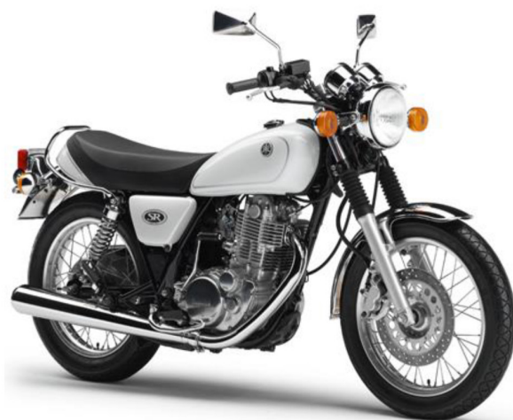
(a) 旧モデル SR400 新車（排気管：装飾 Cr めっき、ナノ膜コーティング無し）
