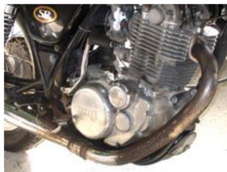
(c) 22,000km 走行後（発錆）
