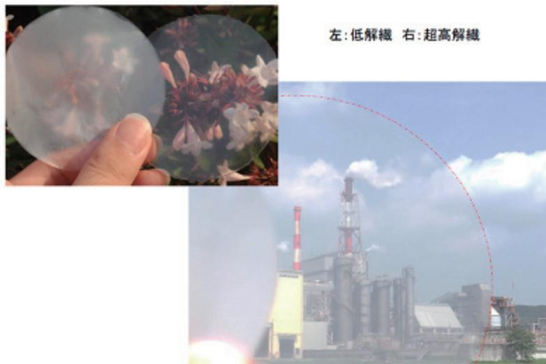
図12 ナノセルロース100%のシート：解繊度合いによる透明性比較 [2]
