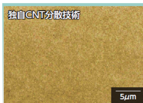
図2 分散剤による従来分散およびニッタのナノ分散状態
