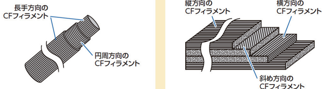
図 13 プリプレグの積層法と CNT/CFRP 成形体
