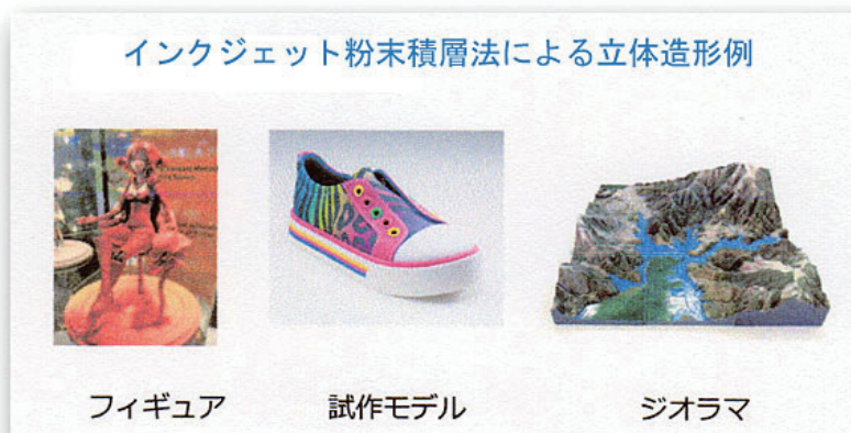
図 13 インクジェット粉末積層法による立体造形例（提供：マイクロジェット）
