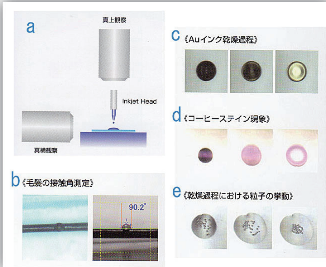
図 21 DropMeasure® によるインクジェット着滴の接触角測定および着滴の乾燥過程の観察（提供：マイクロジェット）
