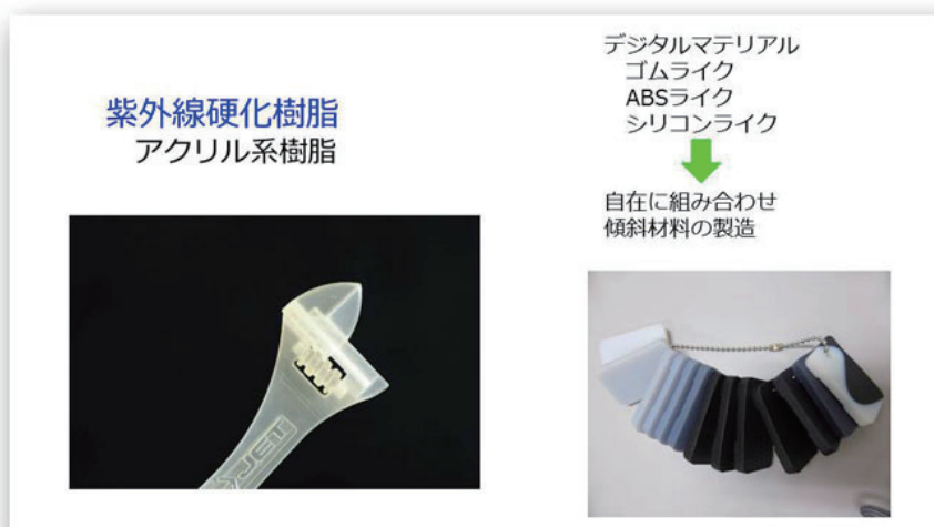
図 16 異なる素材を組み合わせで造形する。左図はスパナ、右図は傾斜材料 (提供：マイクロジェット)
