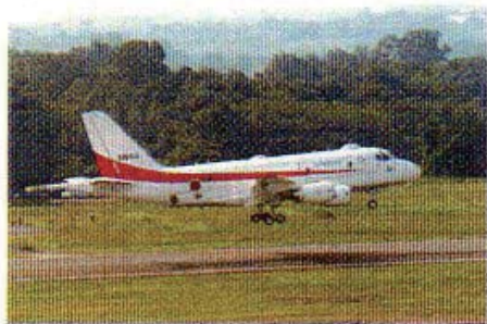
P-1 (国産F7エンジン 4発) 推力13,500lbs (60kN/6,100kg) 民間機転用には双発への転換が必要
