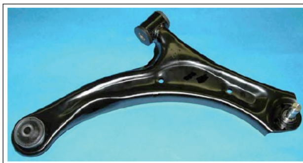
a) 780MPa級NANOハイテンの適用実部品例
