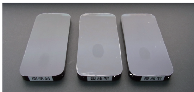
図 12 ナノ凹凸型指紋付着防止フィルムの耐指紋性 (提供: 東レ)
