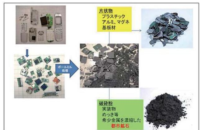
図7 ボールミルによる都市鉱石粉の分離・製造
