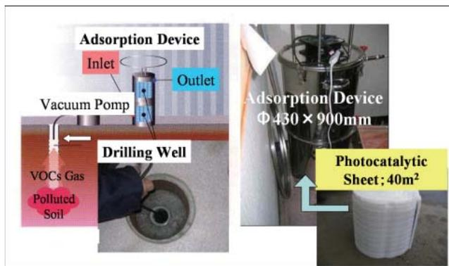
図9 光触媒シートによるドラム缶型 VOC ガス吸着装置
