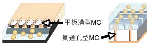
図5 マイクロチャネル乳化による均一径微小液滴の作製 (提供：農研機構食品総合研究所)
