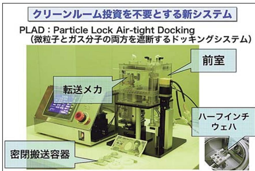
図 8 開発中の局所クリーン化ミニマル搬送システム PLAD 1 号機
