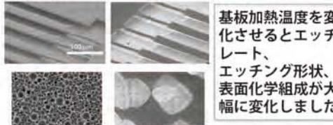
基板加熱温度を変化させるとエッチレート、エッチング形状、表面化学組成が大幅に変化しました
