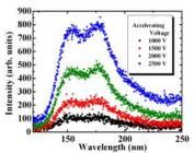
KMgF<sub>3</sub>薄膜を蛍光体としたFEL からの発光スペクトル Output spectra from the field emission lamp using KMgF<sub>3</sub> thin film
