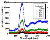
Nd³+:LuF₃薄膜を蛍光体とした FELからの発光スペクトル Output spectra from the field emission lamp using Nd³+:LuF₃ thin film
