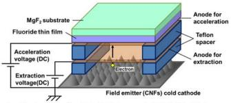
カーボンナノファイバーを電子線源とし、フッ化物薄膜を蛍光体として 用いたフィールドエミッションランプ
