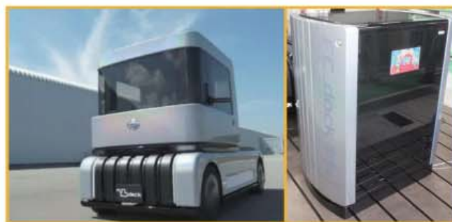
Fig. 5 Spring-8・SACL A構内を走るAEMFCV (左)、定置型FC (右) ※ 撮影協力；Spring-8 (JAEA, JASRI, 理研)
