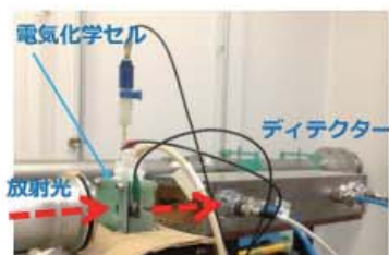
Fig. 1 放射光高度解析装置と解析用セル
