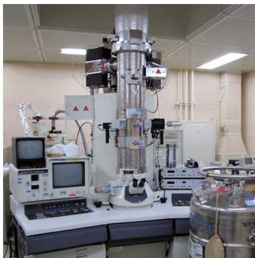
図2 (a) スキルミオン観察に用いられた、300kV 汎用分析型電子顕微鏡 (Hitachi : HF-3000S)
