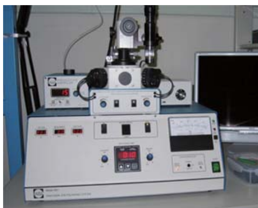
図2 (b) 試料研磨に用いられたイオン研磨装置 (Gatan 社製 PIPS)
