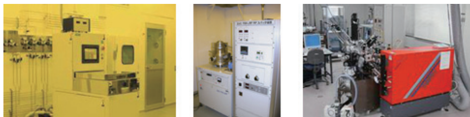
阪大複合機能ナノファウンドリ (左から) リアクティブイオンエッチング装置, RF スパッタ装置, パルスレーザーデポジション装置
