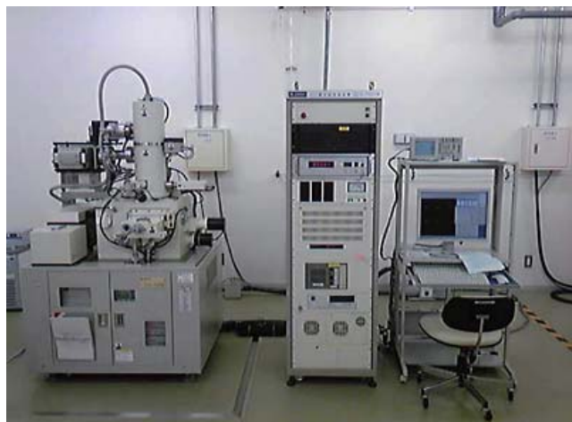
図11 電子線（EB）描画装置 ELS 7500W
