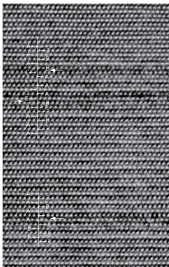
図5 [100] 入射で撮られた積層欠陥の HRTEM 像
