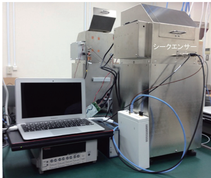
図2 1分子シークエンサーのプロトタイプ。ナノデバイスは、金属箱の中に固定される。
