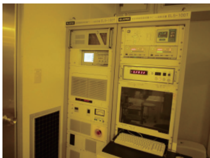
(a) エリオニクス社製 125keV 電子線描画装置 ELS-100T
