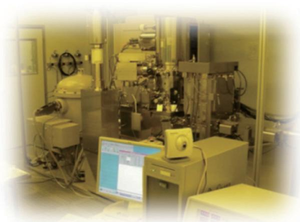
図10 多くのナノ構造造形の実績を持つ電子ビーム露光装置
