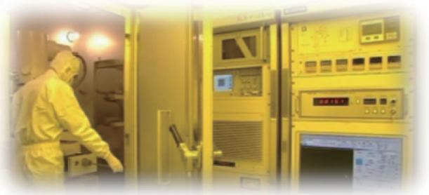
図3 超高精度電子ビーム露光装置(125kV)
