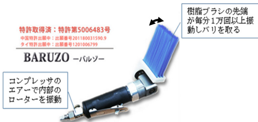
図1 新開発バリ取りツール「BARUZO」（本間商会製品パンフレットからJST作成）
