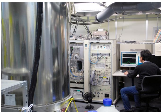
図2 解析に利用した 500MHz 固体 NMR-I. 試料の温度を変化させての観察が可能。
