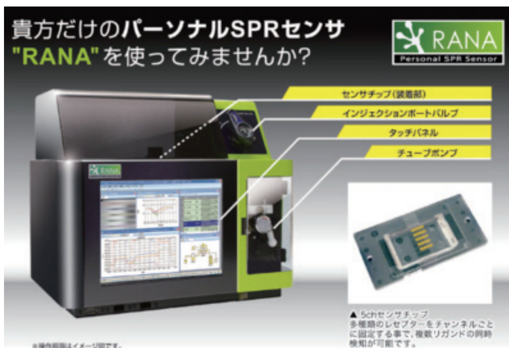
図 4 小型表面プラズモン共鳴センサー
