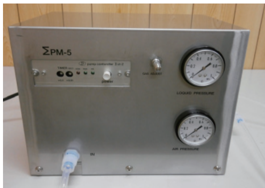
(a) マイクロナノバブル発生装置 ΣPM-5 (b) 作製したナノバブル水 図 2 ナノバブル発生装置とナノバブル水
