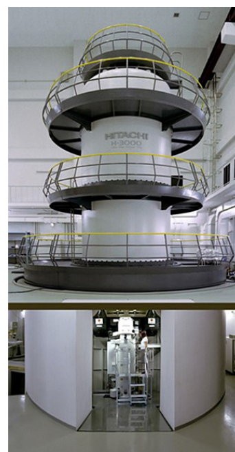
図4 大阪大学微細構造解析プラットフォームの 超高压電子顕微鏡：H-3000
