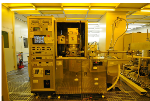
(a) ICP エッチング装置を使った GaN-LED 層の分割エッチング加工
