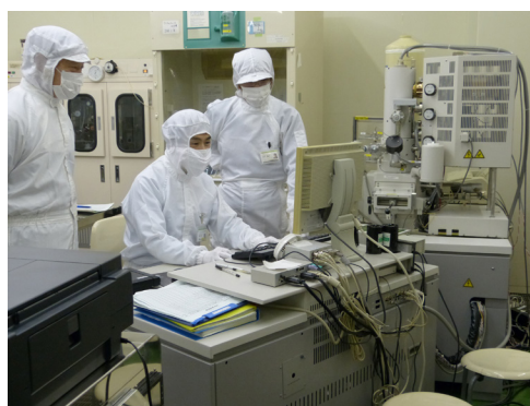
(b) SEM を使った試作サンプルの加工状態の観察
