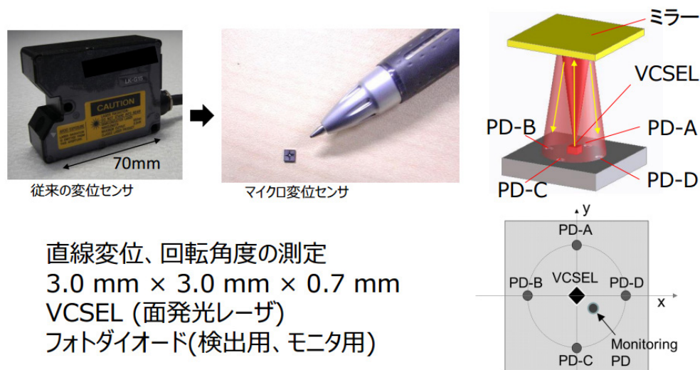
図 3 超小型変位センサの構成（右上）とセンサ面上の配置図（右下）[5]
