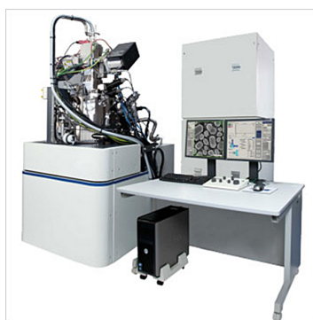
図 3 直交配置型高速加工観察分析装置（FIB-SEM：MI-4000L）
