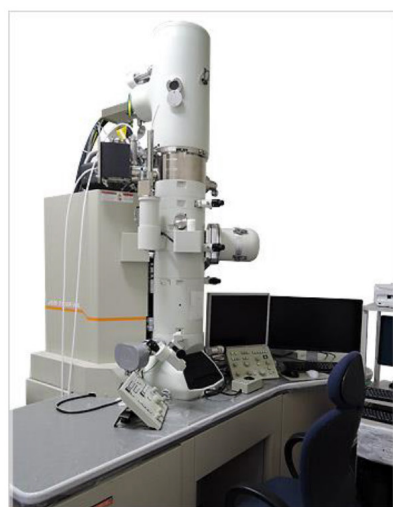
図4 高分解能透過型電子顕微鏡 (JEM-2100F/HK)
