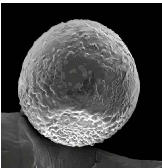
図 7 新規鉛フリーハンダ微粒子の外観 (Sn に Cu を混合し、Sn 中に Sn-Cu ナノ金属間化合物をコンポジット化した機能性微粒子金属。粒径は 1 ~ 10 \mu m の範囲で粒度分布をシャープに制御可能)
