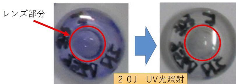
図9 光触媒機能のデモンストレーション。メチレンブルーが消滅した
