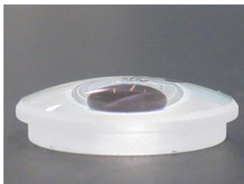
(b) 接触角 $10^\circ$  を達成
