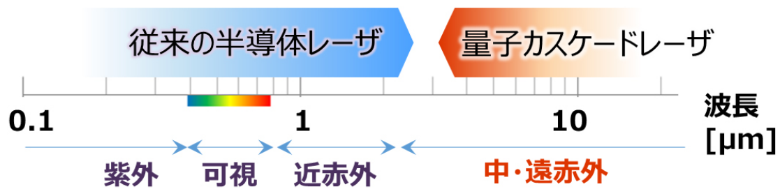
図1 量子カスケードレーザーの発振波長域
