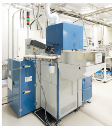
図2 [NPF031]原子層堆積装置 (オックスフォード・インストルメンツ製 FlexAL)
