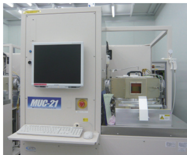
図 6 試作コインランドリの中の Deep RIE 装置
