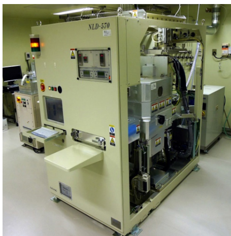
図5 磁気中性線放電ドライエッチング装置（NLD-RIE）
