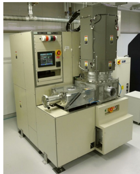
図2 キヤノンアネルバ製多元スパッタ装置
