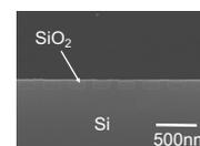
Fig7. 埋め込み膜の平坦化
