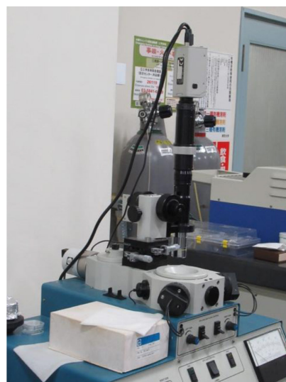
図2 イオンビーム加工を用いた電子顕微鏡試料作製装置 (左：イオンサイザー，右：イオンポリッシャー)
