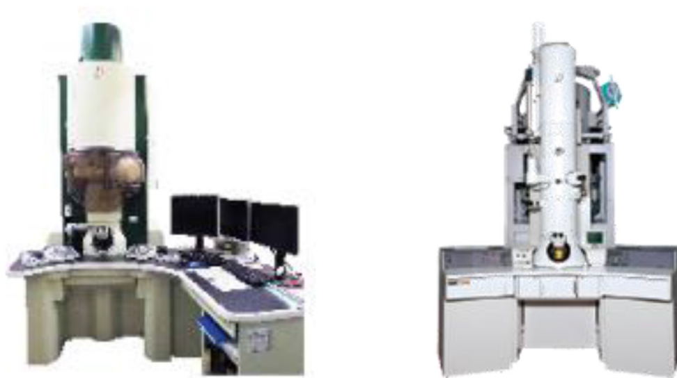
図1 東大微細構造解析 PF の電子顕微鏡例 (左：原子分解能元素マッピング構造解析装置，右：ハイコントラスト透過型電子顕微鏡)
